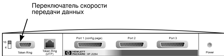
Рис. 3-1 Переключатель скорости передачи данных в сети Token Ring на HP J3264 в положении 16 Мбит/сек
